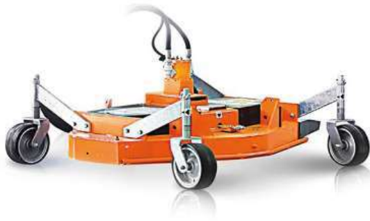
Sichelmähwerk Heck- oder Seitenauswurf 1,20 m / 1,35 m / 1,50 m
