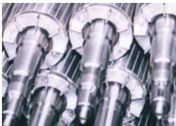
Welle mit aufgedrücktem Rotor
